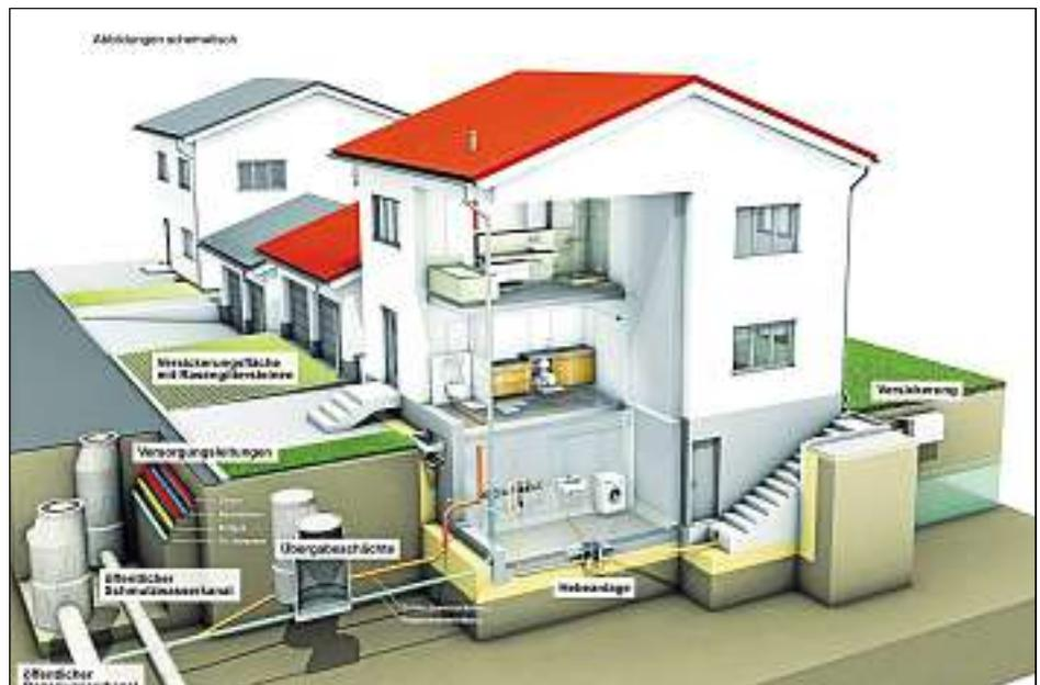
schlagwasser ableiten kann. Verstopfungen oder Ablagerungen im Kanal, Rohrbruch oder der Ausfall eines Pumpwerkes können ebenfalls einen Rückstau verursachen. Bei solchen Kanalüberlastungen steigt das Abwasser bis zur Rückstauenebene an und fließt dann an der Oberfläche ab.
