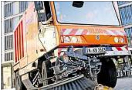
Um so effektiv wie möglich zu arbeiten, haben die Reinigungsstrüps auch zwei Kehrmaschinen zur Verfügung. Extra für die Innenstadtreinigung wurde ein modernes Gerät angeschafft, das mechanisch nach dem sogenannten „Schaufel-Besen-Prinzip“ arbeitet und auf diese Weise die Pflasterfugen besonders schon. Darüber hinaus kann das neue Fahrzeug auch größeren Müll aufnehmen, bei dem andere Kehrmaschinen längst passen müssen. Foto: INKB
