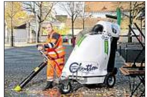
Sieht aus wie ein überdimensionaler Staubsauger und ist im Prinzip genau das: Dank Elektroantrieb fährt der Hightech-Sauger von selbst und kann von den Stadtreinigern ohne Kraftaufwand geführt werden. Mithilfe des Saugrohres aus Carbon kann auch Schmutz an schwer zugänglichen Stellen mühelos entfernt werden. Regenablaufrippen, Fahrradständer, Baumscheiben oder andere potenzielle Hürden sind so kein Problem mehr. Foto: INKB
